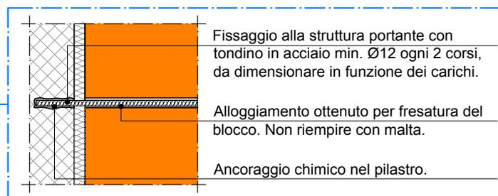
\* Se x (dimensione spalletta) < 60 cm, incollare i blocchi al pilastro e vincolarli meccanicamente senza lasciare nessun giunto elastico.
