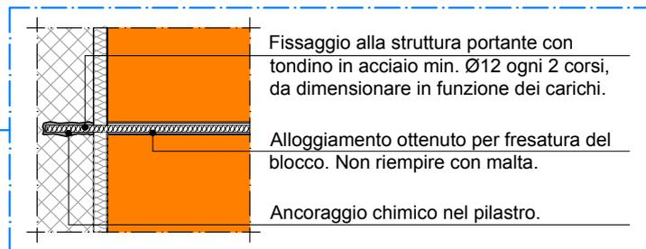
Fissaggio alla struttura portante con tondino in acciaio min. Ø12 ogni 2 corsi, da dimensionare in funzione dei carichi.
